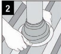
2 Deslice sobre la tubería.
