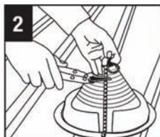
Utilizando las pinzas corte el sellador a la medida del tubo, empezando al contrario de la unión de cierre metalico.
