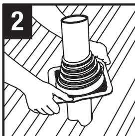
2 Deslice sobre la tubería
